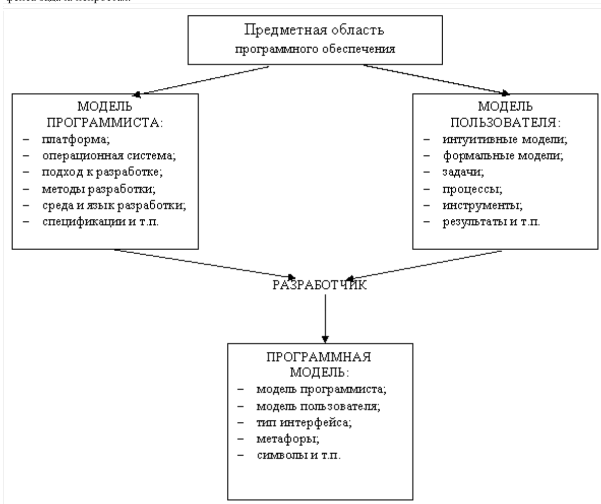
Рисунок 2 – Процесс проектирования пользовательского интерфейса. Интуитивные модели выполнения операций в предметной области должны стать основой для разработки интерфейса, а потому в большинстве случаев их необходимо не менять, а уточнять и
